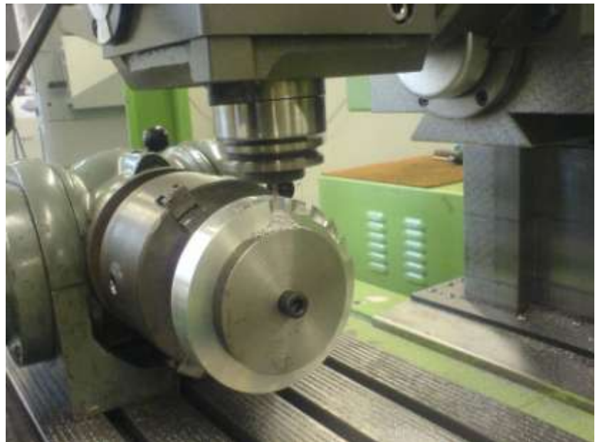
Laufradfertigung auf der Fräsmaschine mit Teilkopfapparat
